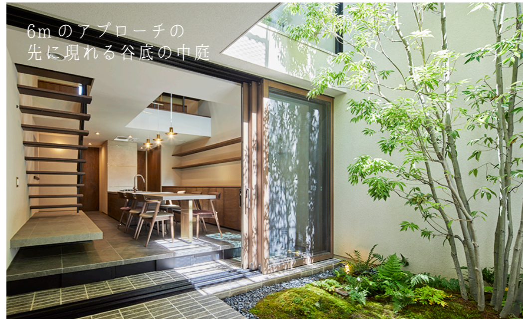
春秋分の8:15 ~ 16:15の太陽光を効率的に反射する位置・大きさに反照板を設置
